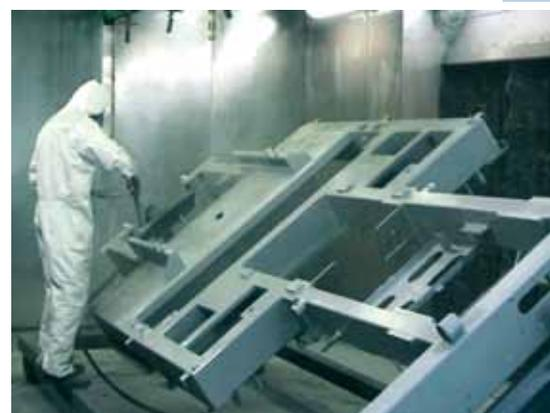
Verniciatura di un telaio
