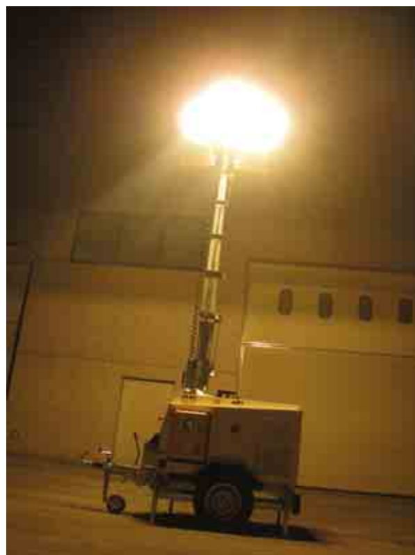
Una dei sistemi antideflagranti Tecnodierre: la torre faro ATEX montata su gomma
