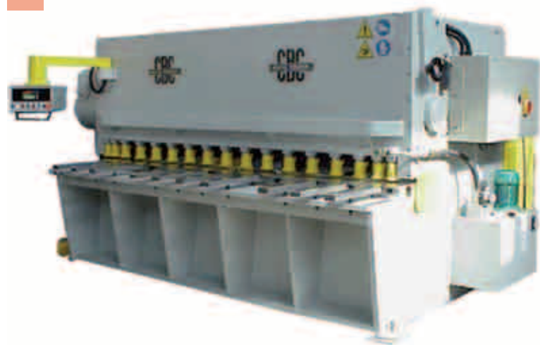
Una delle grandi macchine per la deformazione e il taglio della lamiera della Industrie Meccaniche CBC
