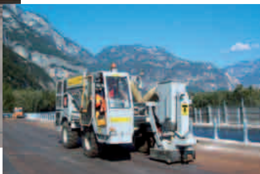
Alcune macchine Trimmer in servizio, per la ristrutturazione di superficie stradali e aeroportuali
